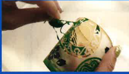
④ 砂を吹き付けたあと、 デザインシールを剥がすと・・・
